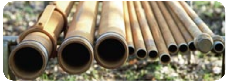
Rohrgestänge für die Spülung
